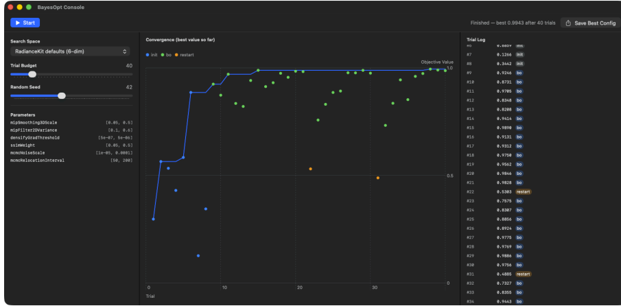
Şekil 25: 40 deneme sonrası BayesOpt konsolu — Trial 15'e kadar dik yükselen Convergence grafiği, 40 denemeden sonra Best Value 0.9943, init/bo/restart etiketleriyle Trial Log
